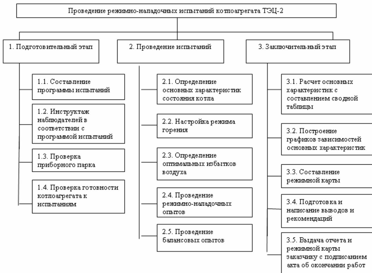
Рис. 2. Структурная декомпозиция работ режимно-наладочных испытаний
